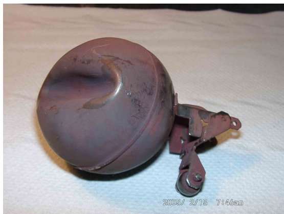
Rysunek 9. Uszkodzenie pływaka kulowego odwadniacza pływakowego na skutek uderzenia wodnego.
