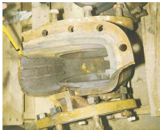
Rysunek 6. Żeliwne zasuwy rozerwane na skutek uderzeń wodnych w rurociągach parowych.
